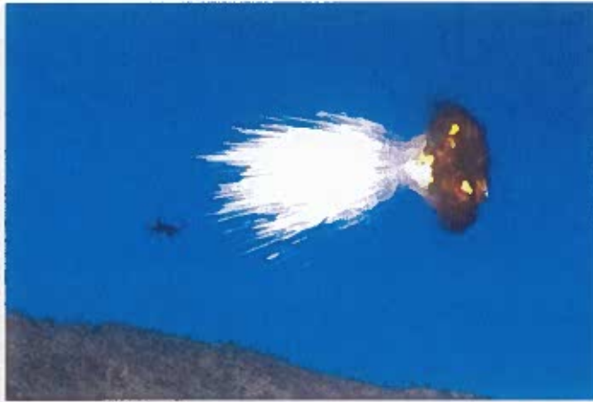
Lovituri 35 mm AHEAD — muniție programabilă cu sub-proiectile
