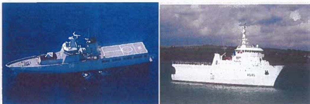
Navă de patrulare maritimă tip OPV — derivată din clasa K130 / NVL Tarmo; vedetă de intervenție pentru scafandri tip DSV
